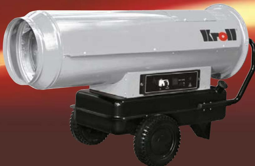
*Chauffages mobiles fioul sans cheminée. Les appareils sont utilisables à l'extérieur et dans des locaux bien aérés, avec un rendement de 100%. Les modèles GK sont équipés d'un compresseur, les modèles GP d'une pompe à haute pression et d'un filtre réchauffeur.*
