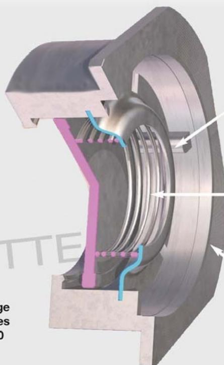
Nervure de guidage du clapet permettant un meilleur centrage
